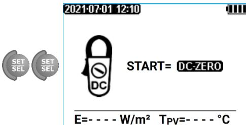
Wenn Sie **START** drücken, wird das Gerät zurückgesetzt, so dass das Messgerät Nullstrom anzeigt. Erst dann können Sie die Zangen an das geprüfte Objekt anschließen.
